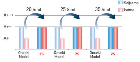
**DC PAM inverter** teknolojisi, hem ısıtma hem de soğutmada yüksek enerji tasarrufu ve verimlilik değerleri sunar. **Inverter** sürücülü bir sistem, sabit hızlı sistemlere göre birçok performans avantajına sahiptir. Örneğin, değişken kompresör hızı, ilk kalkıştan sonra hızlı ısıtmayı sağlar. Daha sonra enerji tasarrufu sağlamak ve konfor koşullarını korumak için kompresör hızını düşürebilir.
