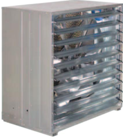
Duvar tipi egzost fanları iç mekanda biriken sıcak ve kirli havayı aksiyel fan vasıtasıyla tahliye etmektedir. Evaporatif Soğutma kullanılan ve iç ortam nem miktarının değişmemesi istenen uygulamalarda içeri verilen havanın %70-80 oranında tahliye edilmesi durumunda nem miktarı dengelenir ve sürekli sirkülasyon sağlanmış olur.
